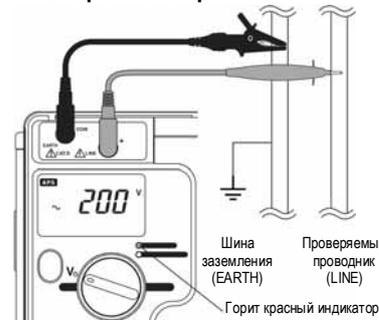
**Замечание:** прибор автоматически определяет режим измерения переменного или постоянного тока.
